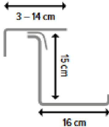
*Dispositif de fixation invisible
